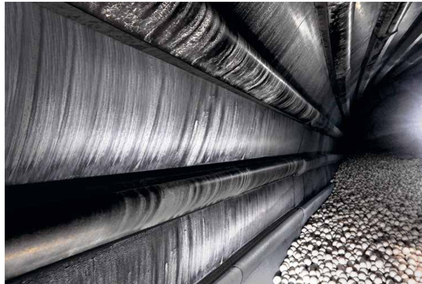
Vista interna della prima camera di un mulino continuo classificante con capacità di 60.000 litri. Internal view of the first chamber of a continuous sorting mill with a capacity of 60,000 litres. Vista interna de la primera cámara de un molino continuo clasificante con capacidad de 60.000 litros. Vue interne de la première chambre d'un moulin continu de classification doté d'une capacité de 60 000 litres.
