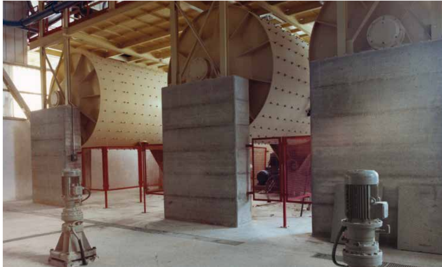
Batteria di mulini discontinui con fondi pari. Set of discontinuous mills with flat bottom heads. Batería de molinos discontinuos con fondos pares. Batterie de moulins discontinus avec fonds plats.
