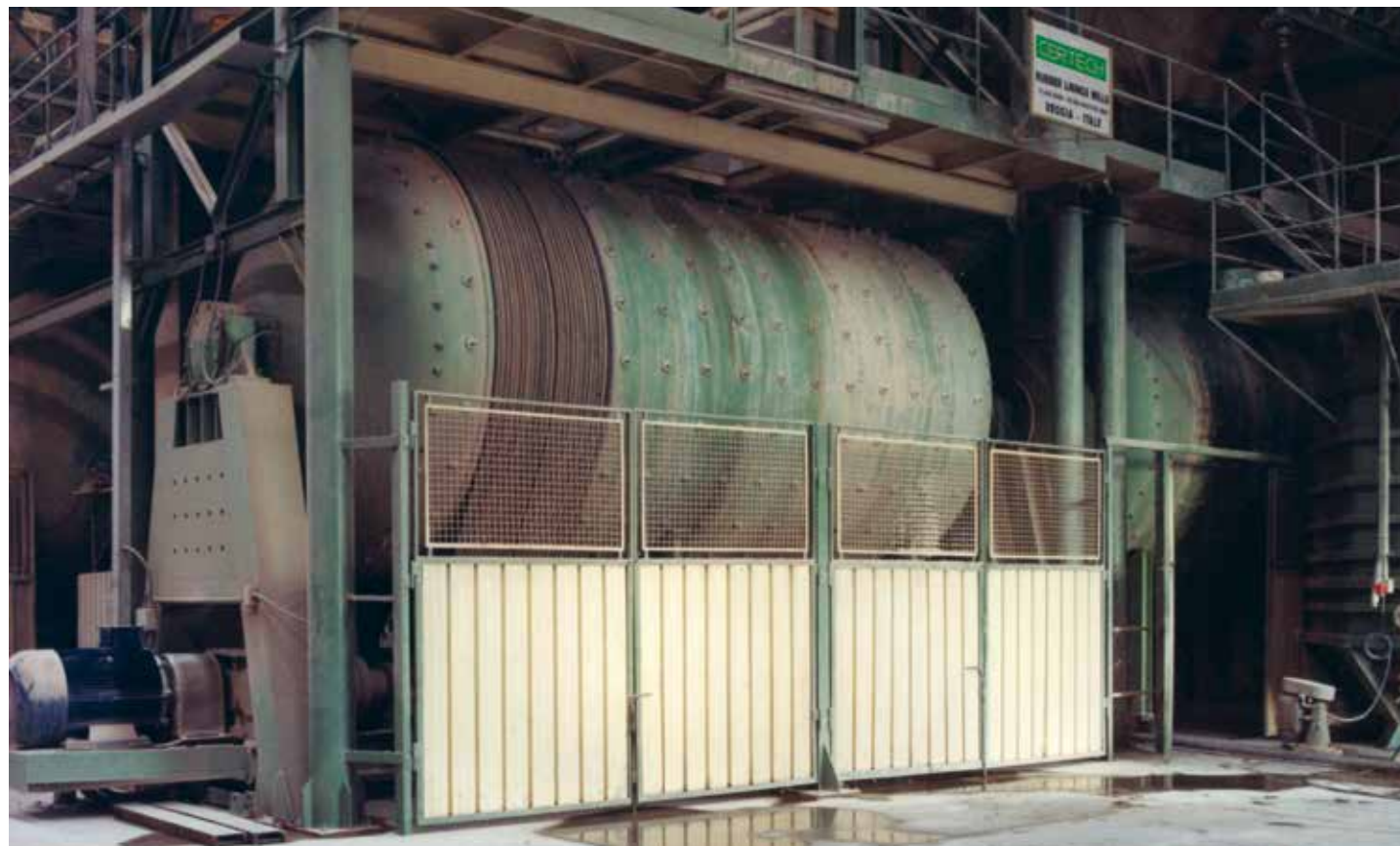
Batteria di mulini discontinui con fondi bombati. Set of discontinuous mills with rounded bottom heads. Batería de molinos discontinuos con fondos abombados. Batterie de moulins discontinus avec fonds bombés.
