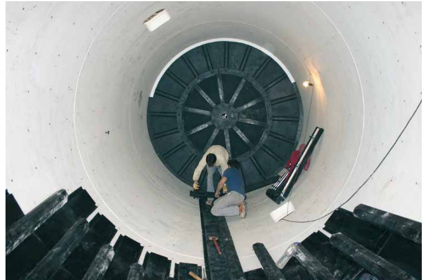
Montaggio del rivestimento in gomma in un mulino con capacità di 160.000 litri. Installation of the rubber lining on a mill with a capacity of 160,000 litres. Montaje del revestimiento de goma de un molino con capacidad de 160.000 litros. Montage du revêtement en gomme dans un moulin doté d'une capacité de 160 000 litres.
