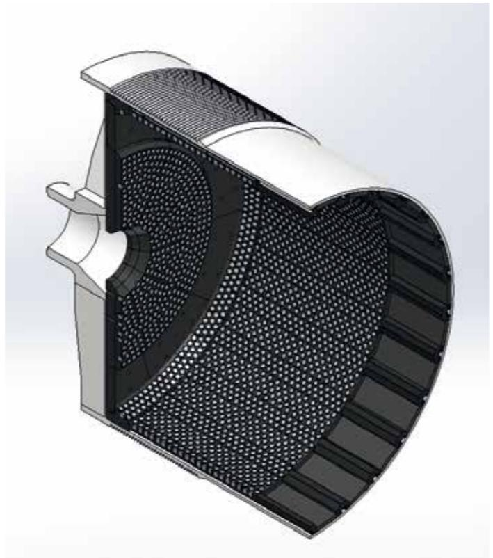
ALURUBBER offre la flessibilità dei tradizionali rivestimenti in gomma, dato che nasce come rivestimento in gomma a profilo liscio, composto da lifter più piastra. Per questo si può installare su qualsiasi mulino: continuo o modulare continuo. Nelle zone di maggiore usura, il rivestimento ALURUBBER viene utilizzato anche nella testata e nel raccordo tra cilindro e testata.
