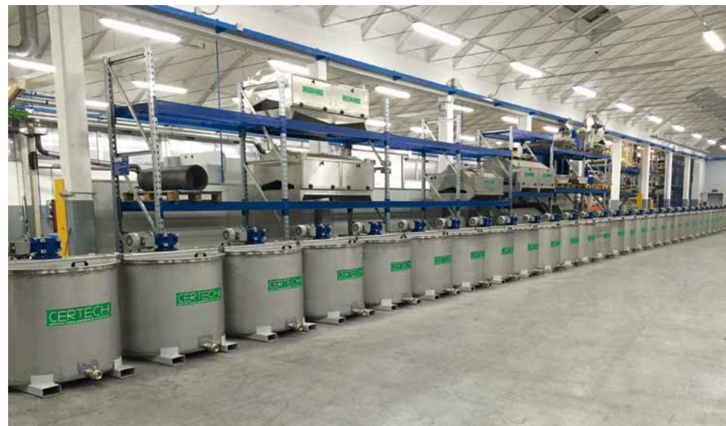
Batteria di vasche costruite in acciaio inox con agitatore a rastrello. Tanks battery built in stainless steel with rake stirrer. Batería de tanques construidas en acero inoxidable con agitador de rastrillo. Batterie de cuves construites en acier inoxydable avec agitateur à râteau.
