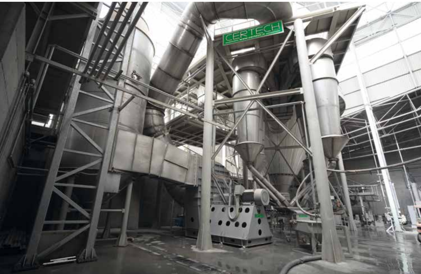
Atomizzatore tipo CSD 20.000 con torre di abbattimento ad umido. Spray drier type CSD 20.000 with wet scrubber tower. Atomizador tipo CSD 20.000 con torre de abatimiento de húmedo. Atomiseur type CSD 20.000 avec tour d'abattage par voie humide.
