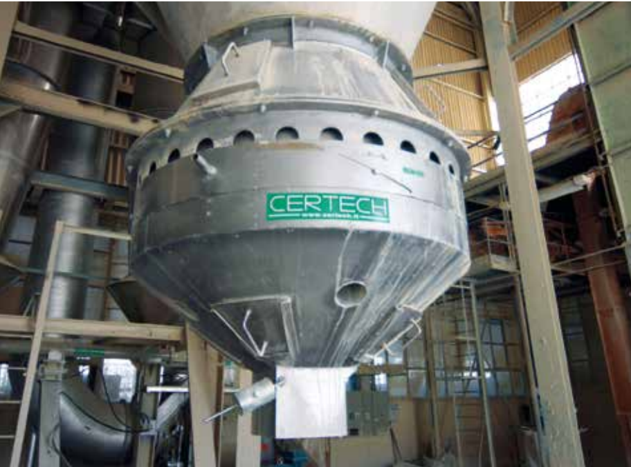
Raffreddatore per polvere atomizzata da installare sotto l'atomizzatore (punto 8). Cooler for spray-dried powder to install under the spray drier (point 8). Enfriador para polvo atomizado a instalar abajo del atomizador (punto 8). Refroidisseur pour poudre atomisée à installer sous l'atomiseur (point 8).
