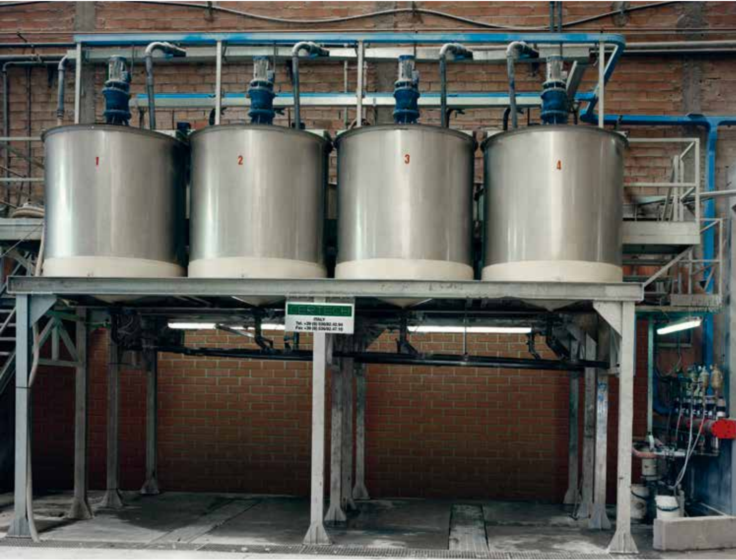
Vasche di contenimento pigmenti complete di agitatore (punto 1). Pigments containing tanks complete with stirrer (point 1). Tanques de contención de pigmentos completas de agitadores (punto 1). Cuves à pigments avec agitateur (point 1).
