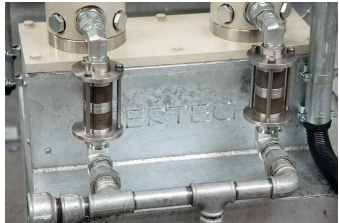
Dettaglio doppia valvola a sfera sulla tubazione di aspirazione. Detail of a double ball valve on a suction pipe. Detalle doble válvula de esfera en el tubo de aspiración. Détail deux vannes à bille sur la tuyauterie d'aspiration.
