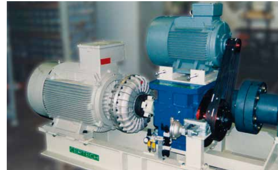
Dettaglio motore principale e motore avvio e posizionamento. Detail of the main motor and starting/positioning motor. Detalle motor principal y motor de arranque y posicionamiento. Détail moteur principal et moteur de démarrage et de positionnement.
