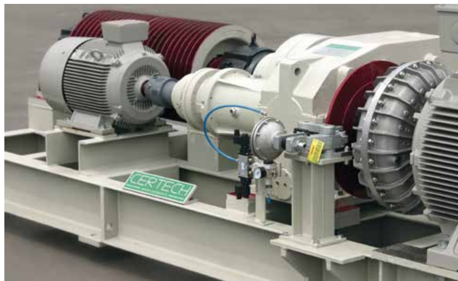
Motorizzazione tipo MRC 38. Dettaglio motore di avvio e posizionamento, ruota libera, riduttore epicicloidale, riduttore principale, sistema frenante e giunto idraulico. MRC 38 motorization unit. Detail of the starting and positioning motor, free wheel, epicyclic reduction gear, main reduction gear, braking system and hydraulic coupling. Motorización tipo MRC 38. Detalle motor de arranque y posicionamiento, rueda libre, reductor epicicloidale, reductor principal, sistema de freno y junta hidráulica. Motorisation type MRC 38. Détail moteur de démarrage et positionnement, roue libre, réducteur épicycloïdal, réducteur principal, système de freinage et coupleur hydraulique.
