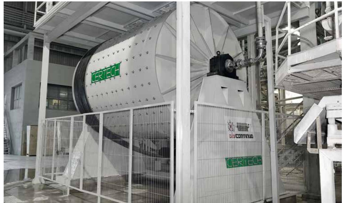
Mulino continuo raffinatore installato dopo un mulino continuo. Refining continuous mill installed after a continuous mill. Molino continuo refinador instalado después de un molino continuo. Broyeur continu raffineur installé après un broyeur continu.
