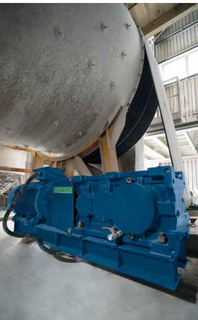
Motorizzazione con riduttore ortogonale installato su primo modulo.
