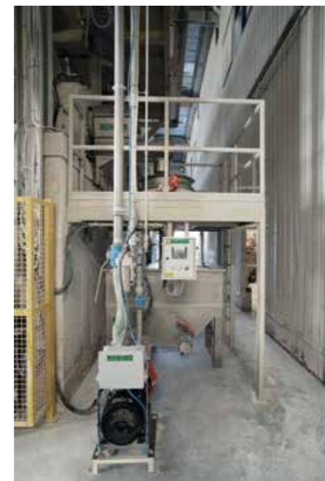
Pompa centrifuga di trasferimento barbotina da 1° a 2° o 3° modulo.
