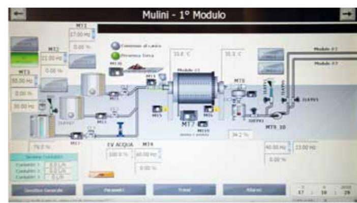
Dettaglio schermata 1° modulo. Detail of the 1<sup>st</sup> module screenshot. Detalle de la captura de pantalla del 1er módulo. Détail de la capture d'écran du 1<sup>er</sup> module.
