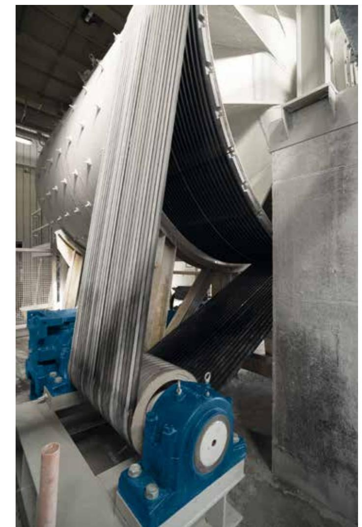
Gruppo puleggia e zona cinghie con gole composta da pannelli in speciale polimero. Pulley group and belt zone with grooves composed by special polymer panels. Grupo polea y zona correas con ranuras compuesta por paneles en polímero especial. Groupe poulie et zone courroies avec gorges composites par panneaux en polymère spéciale.
