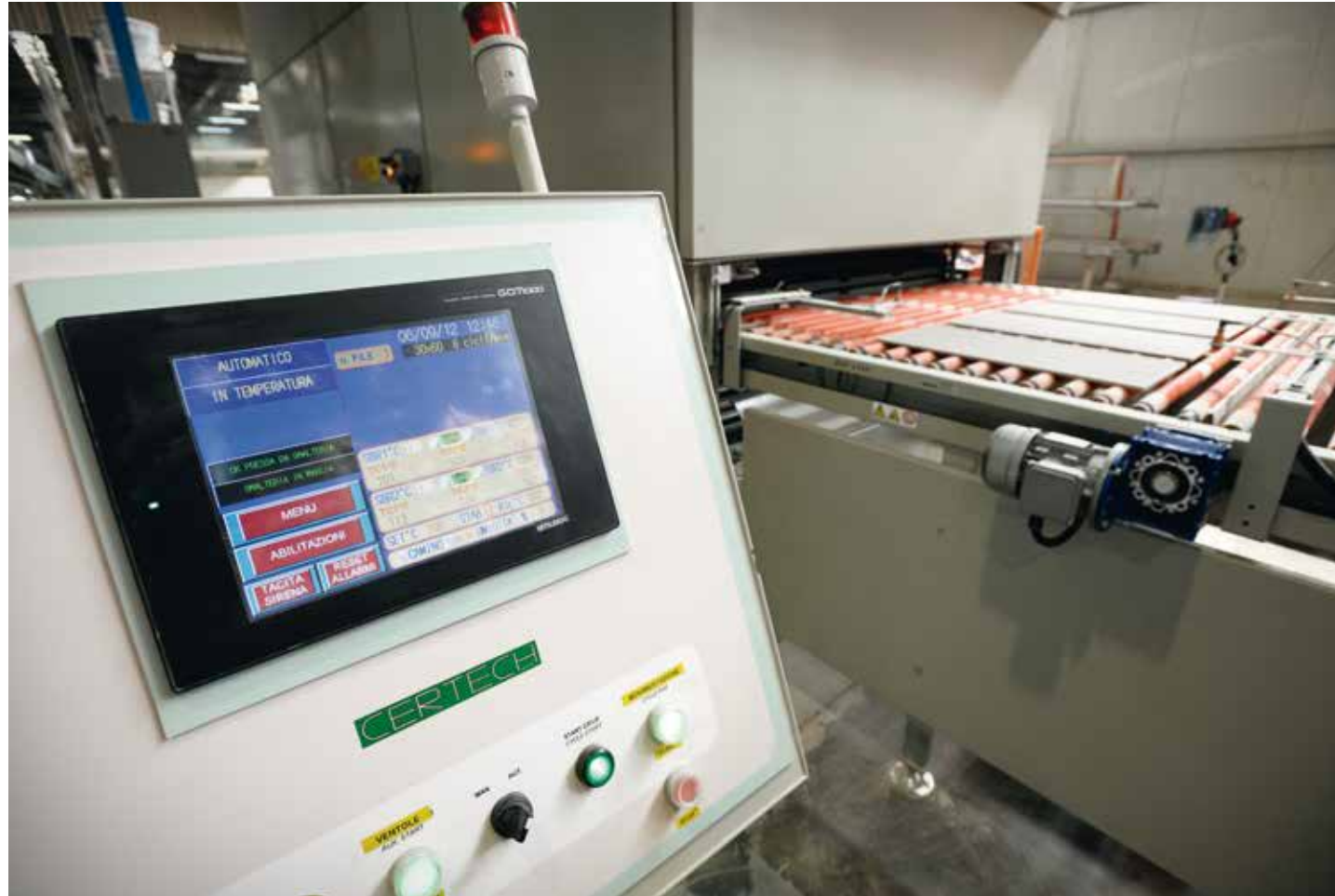
Dettaglio rulliera di carico essiccatoio e quadro di comando essiccatoio con monitor touch screen da 10". Detail of the drier loading roller way and drier control board with 10" touch screen. Detalle cinta de carga secadero y tablero de mando secadero con monitor de pantalla táctil de 10". Détail train de rouleaux de chargement séchoir et tableau de commande séchoir avec moniteur à écran tactile de 10".
