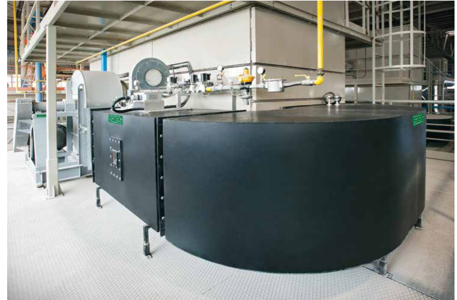
Ventilatore principale e bruciatore in vena d'aria da 600.000 Kcal/h. Main fan and duct burner with a capacity of 600,000 kcal/h. Ventilador principal y quemador en vena de aire de 600.000 Kcal/h. Ventilateur principal et brûleur en veine d'air de 600.000 kcal/h.
