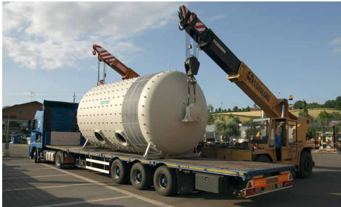
Molino ICF con capacità di 38.000 litri durante il carico. ICF mill with capacity of 38.000 Lt, during the loading. Molino ICF con capacidad de 38,000 litros revisado, durante la carga. Broyeur ICF d'une capacité de 38.000 litres pendant la charge.
