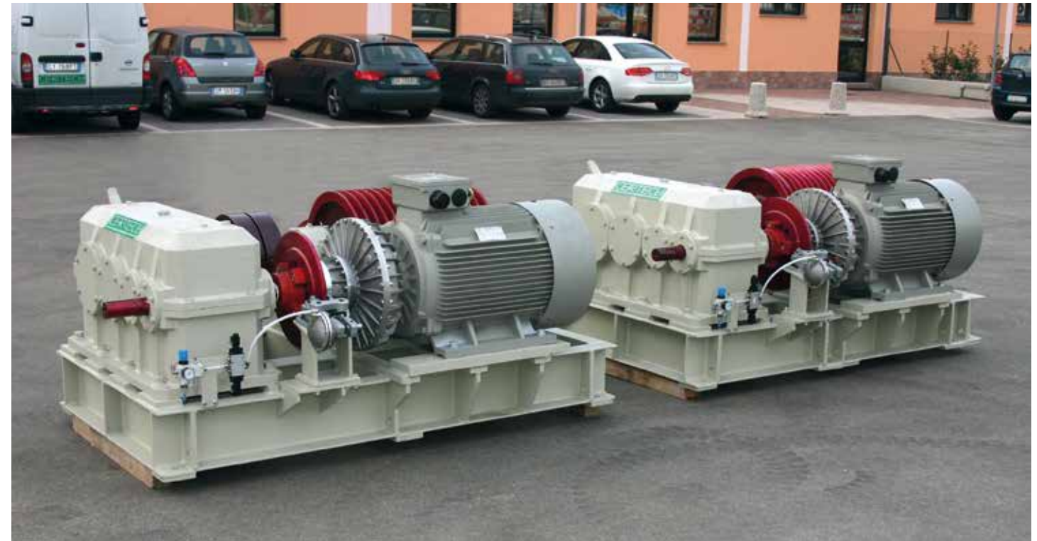
Nr. 02 motorizzazioni revisionate, per mulino OMS / NASSETTI con capacità di 34.000 litri. Nr.02 regenerated motorizations for OMS / NASSETTI mill with capacity of 34.000 Lt. 02 Motorizaciones revisadas , para molinos OMS/NASSETTI con capacidad de 34.000 litros. Nr. 02 motorisations révisées, pour moulin OMS / NASSETTI d'une capacité de 34.000 litres.
