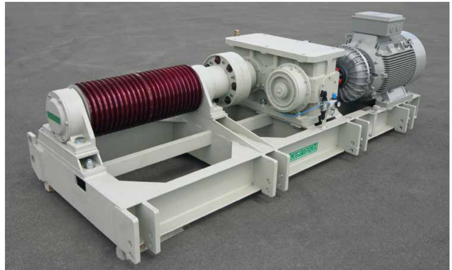
Motorizzazione per mulino ICF con capacità di 38.000 litri revisionata. Regenerated motorization for ICF mill with capacity of 38.000 Lt . Motorizacion para molino ICF con capacidad de 38,000 litros revisada. Motorisation pour broyeur ICF d'une capacité de 38.000 litres révisés.
