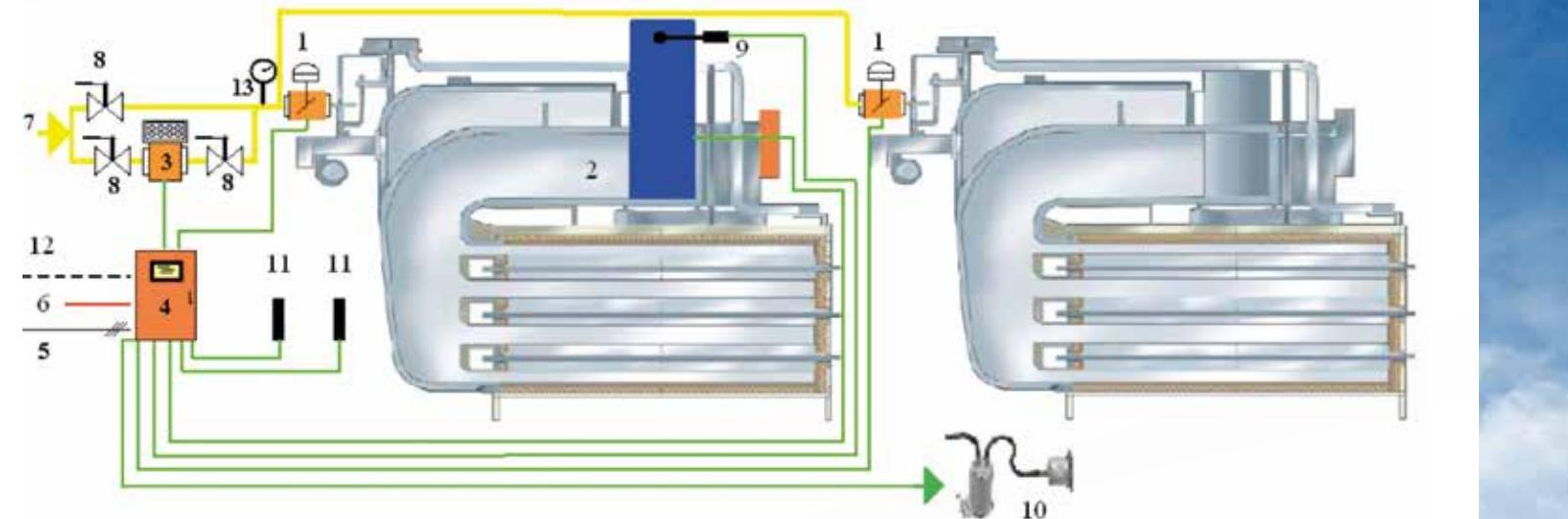
Nel caso l'essiccatore non sia fornito di contatore del gas viene offerto in opzione il suo montaggio. Il contatore è necessario in quanto è l'unica misura possibile per controllare il risparmio di gas.
